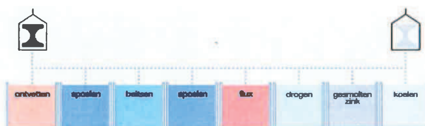
Basisproces discontinu thermisch verzinken
